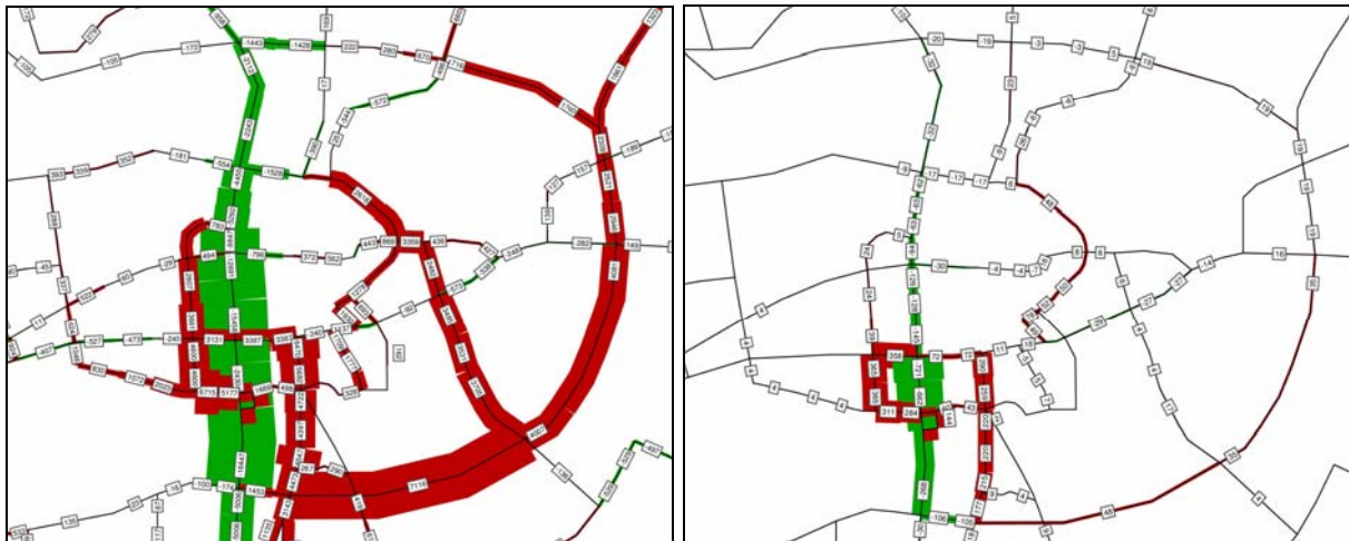
Abbildung 7.10: Sensitivitätsanalyse 1: Verkehrsbelastungsbilder für die Fahrzeugkollektive „Kfz“ (links) und „Lkw“ (rechts) zur Annahme „Sperrung“ in der Bahnhofstraße in Höhe der Messstation als Differenzdarstellung gegenüber dem Analysefall [ETC 2005]
