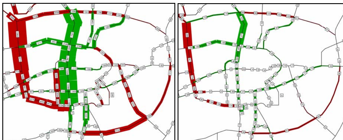
Abbildung 7.8: Ergebnis der Verkehrsmodellrechnungen: Verkehrsbelastungsbilder für die Fahrzeugkollektive „Kfz“ (links) und „Lkw“ (rechts) zu den Verkehrsinfrastrukturmaßnahmen des Luftreinhalteplans 2010 als Differenzdarstellung gegenüber dem Basisfall 2006 [ETC 2005]
