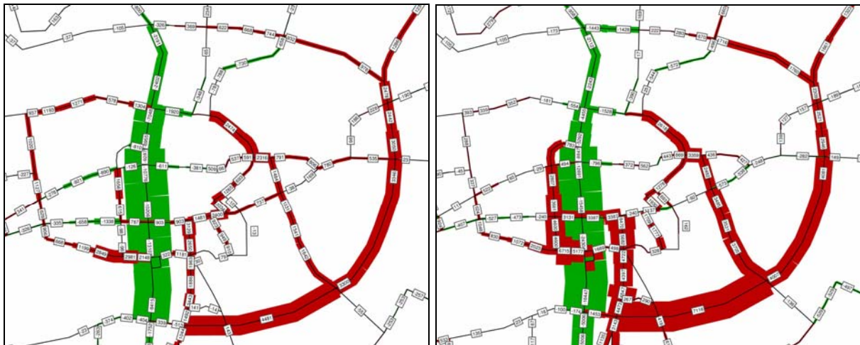
Abbildung 7.11: Sensitivitätsanalyse 2: Kfz-Verkehrsbelastungsbilder zum Vergleich der Annahmen „Einbahnstraße“ (links) und „Sperrung“ (rechts) in der Bahnhofstraße in Höhe der Messstation als Differenzdarstellung gegenüber dem Analysefall [ETC 2005]
